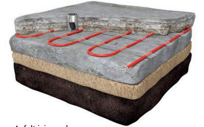
Asfalt içi uygulama
