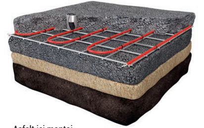
Asfalt içi montaj
