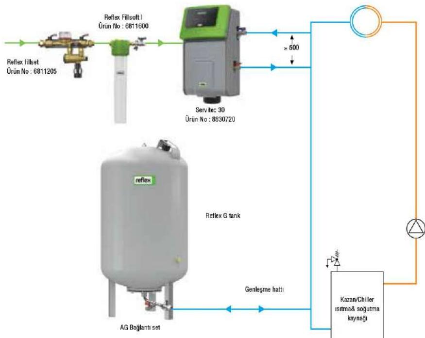
Servitec 30 ve Fillset RPZ vana ile birlikte statik tank. Eğer tanktaki su kritik seviyeye düşerse Servitec cihazı ile üniteye su şebekesinden gereği kadar su doldurulur.
